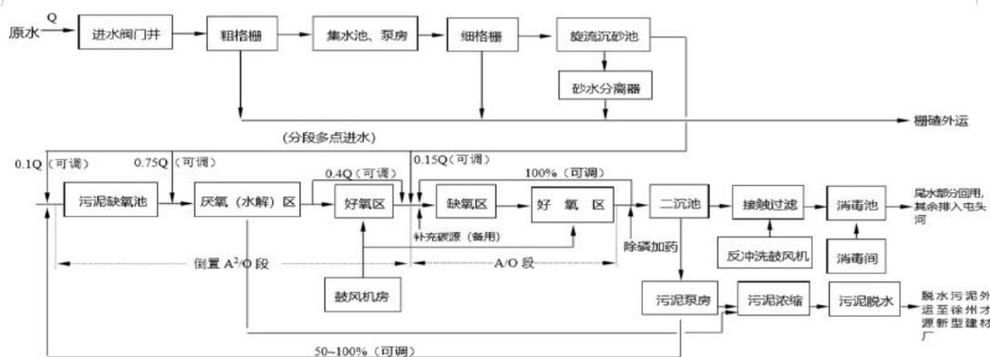
图 2.1-3 生产工艺流程图
