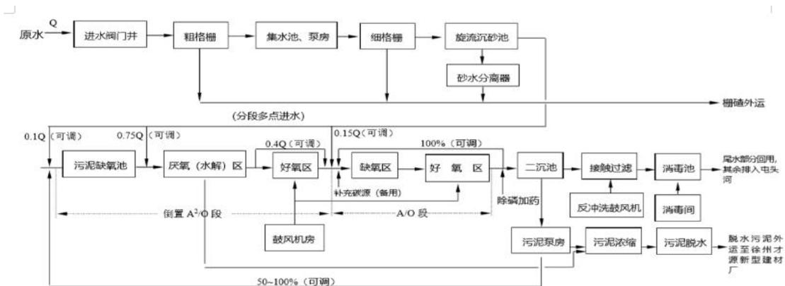
图 1.4-1 生产工艺流程图
